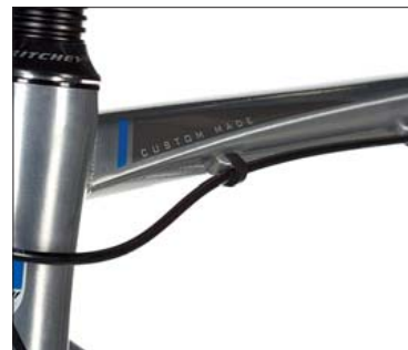
Die spannungsreiche Form des Oberrohrs spart Gewicht und soll durch optimierten Querschnitt auch hohe Rahmensteifigkeit bereitstellen.
